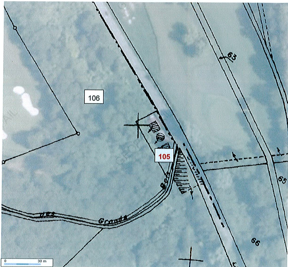
Figure 6 : Limites du périmètre de protection immédiat du captage de Sailly sur extrait de plan cadastral (Geoportail)
